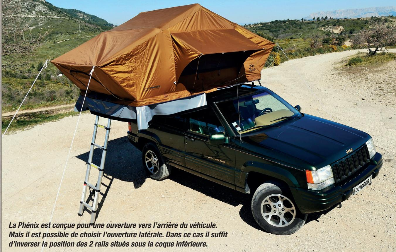
*La Phénix est conçue pour une ouverture vers l'arrière du véhicule. Mais il est possible de choisir l'ouverture latérale. Dans ce cas il suffit d'inverser la position des 2 rails situés sous la coque inférieure.*
