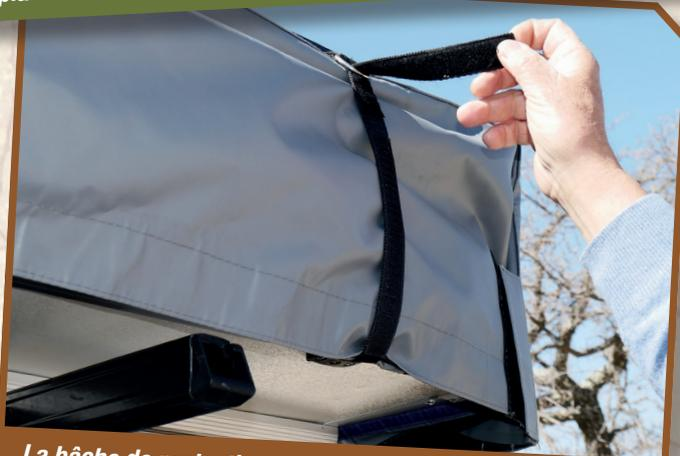
*La bâche de protection est ultra solide. Elle est solidement fixée au châssis par une grosse bande velcro qui en fait tout le tour avec 4 attaches de sécurité aux angles.*
