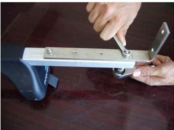
Fixez les supports sur vos barres à l'aide des boulons de 6 mm en appliquant la force de serrage nécessaire.
