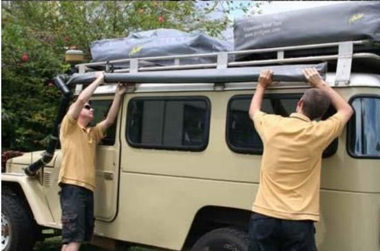
Assurez-vous que l'auvent est dans le bon sens. Utilisez deux personnes pour le soulever, le positionner et fixer les boulons à l'arrière de la plaque de montage sur les supports de fixation.
