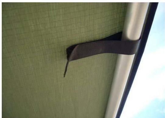
Attachez l'auvent à la structure au moyen des sangles velcro.
