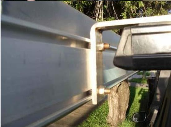
Fixez l'auvent sur les supports de fixation à l'aide des boulons de 6 mm.
