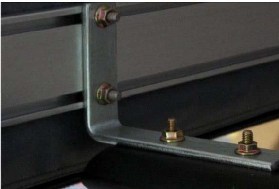
Assurez-vous que le diamètre des boulons coulissants (6 mm) est adapté aux supports de fixation. Placez les supports au-dessus des barres et fixez-les au moyen d'une rondelle, d'une bague fendue et d'un écrou.
