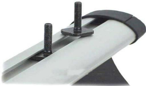
La plupart des barres de toit sont munies de rails de fixation qui permettent d'utiliser des boulons coulissants pour fixer les supports en L.
