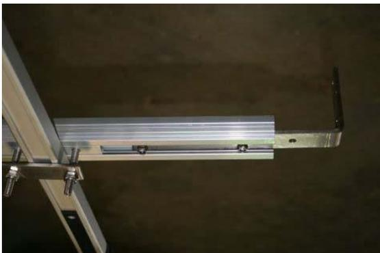
Insérez-les jusqu'à la position souhaitée et fixez-les sur les rails de fixation à l'aide des écrous.
