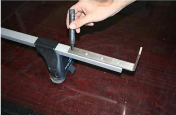
Assurez-vous que les supports en L sont alignés et situés à la distance souhaitée par rapport à votre véhicule avant de marquer les trous de perçage sur les barres.
