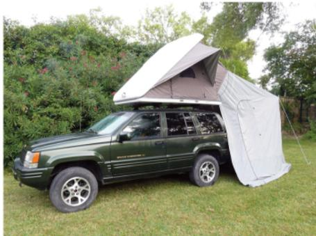
L'annexe est maintenue en position en plaçant les tuteurs télescopiques aux extrémités et en insérant dans les deux oeillets
