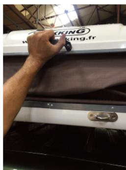
Soulever légèrement le capot supérieur afin de faciliter l'ouverture automatique assurée par les deux vérins
