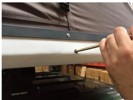
Mise en place des auvents. Insérer les tiges flexibles dans les orifices prévus, avec un angle de 30° vers l'extérieur.
