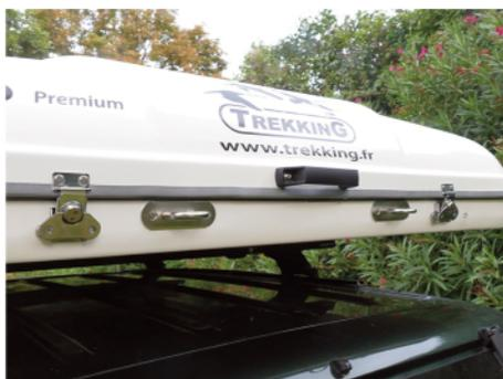
Deux crochets sont fixés à l'arrière de la tente et sur les côtés droit et gauche. Ces crochets sont prévus pour retenir les échelles spécifiques TREKKING
